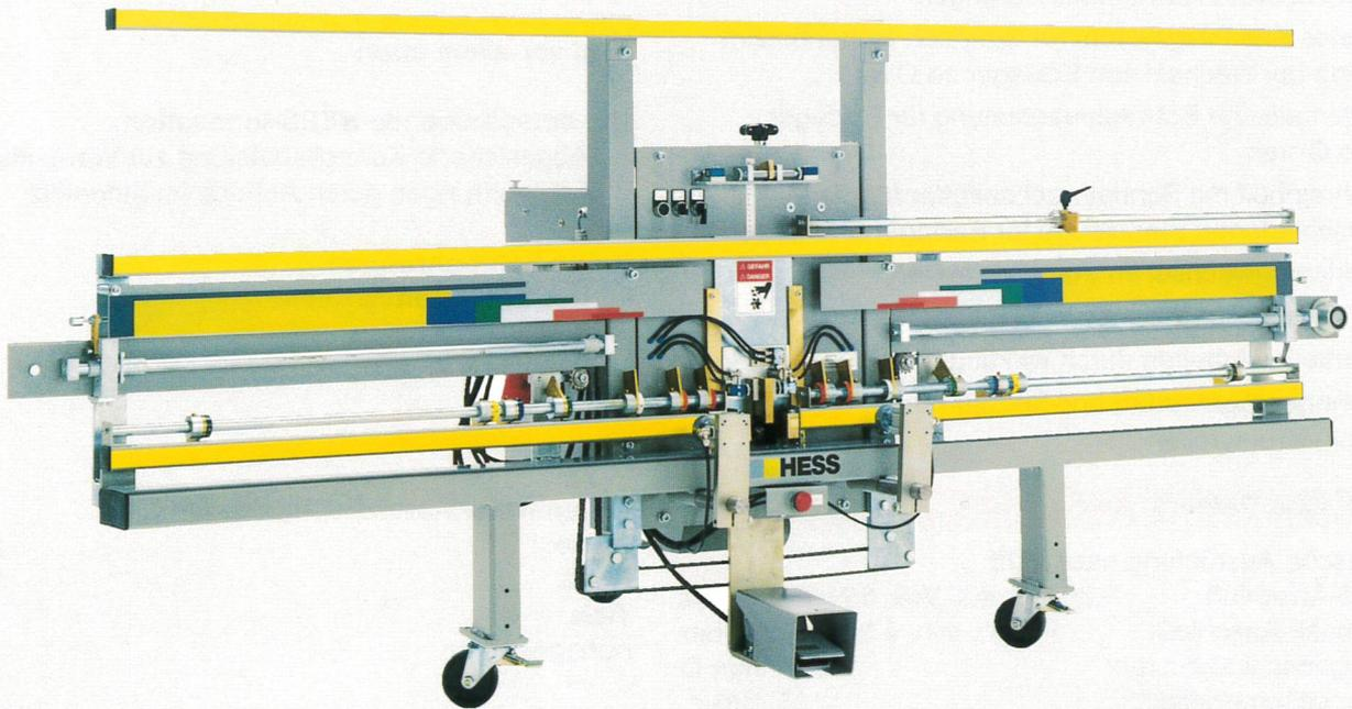
Zusatzausrüstungen: Automatische Höhenabastung, Zentrier-Einrichtung, Anschlag-System für Bohrungen am Pfosten
