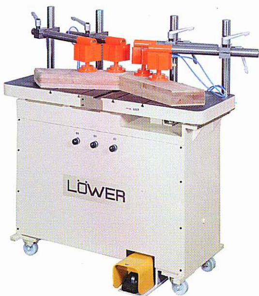
Als MZP 2 in verstärkter Ausführung für große Querschnitte (Türen- und Wintergartenbau etc.). Zwei zusätzliche Spannzylinder sowie ein zusätzlicher Preßzylinder erhöhen die Preßkraft.
