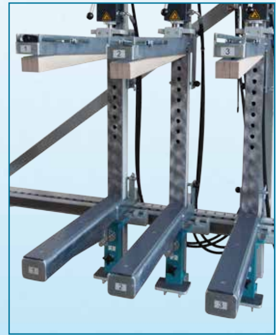
Zulagen für die Verpressung von Korpusen Accessory supports for pressing carcasses
