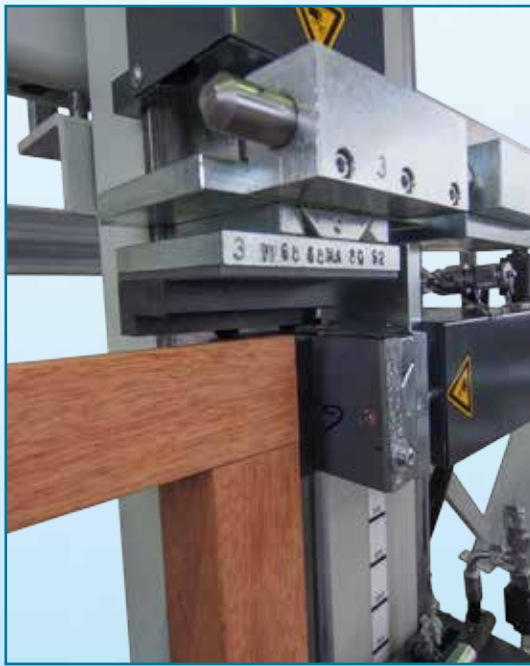
Konterprofilaustrüstung zum Verpressen außenprofilierter Rahmen Counter profile equipment for pressing outside profiled frames
