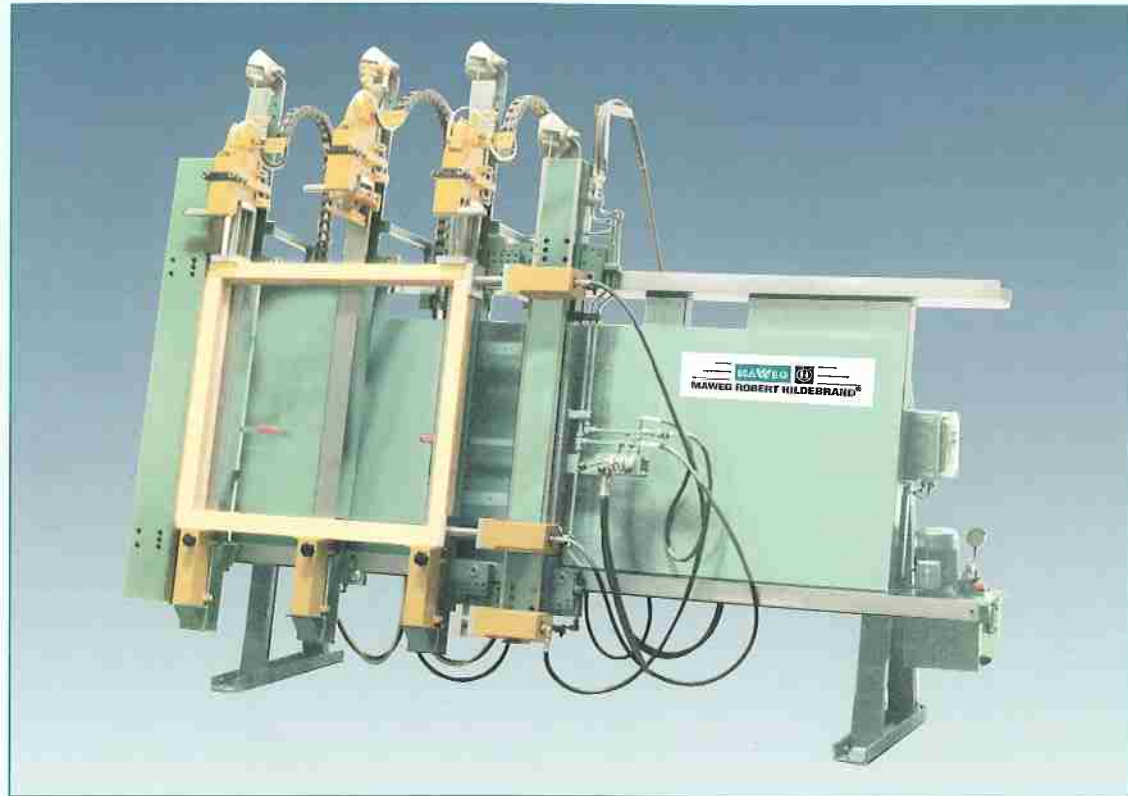
Größeneinstellung mit Einzelhölzern und losem Ein- legen in die Presse Euronova Z
