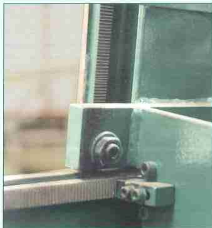
Zahnstangen- klemmung für Quickomat U-Z und Euronova Z
