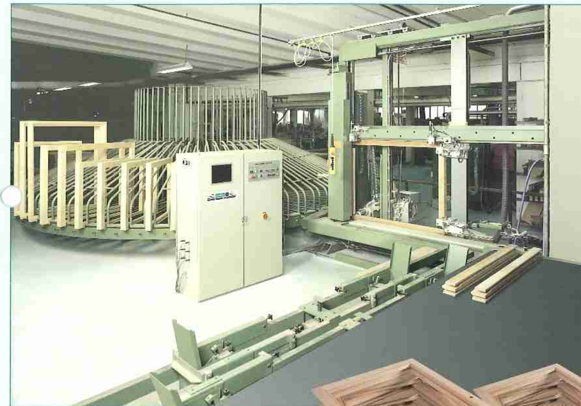
Rahmenpresse Quickomat R 3000 mit Online- Computeran- schluß, auto- matischem Ein- legen, Austransport, Rahmenspeicher und computerge- steuerter Leimab- gabe
