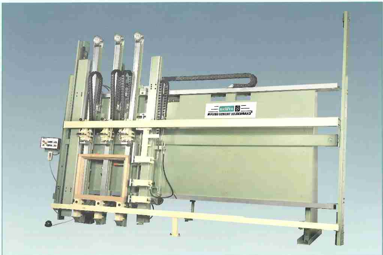
Rahmenpresse Quickomat U-Z mit automatischer Maßeinstellung
