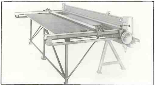
Präzisionsanschlagstisch HP 361 , an der Rückseite angebaut, nur für 3100 mm Schnittlänge. Anschlagtiefe 1240 mm; durch einen einschiebbaren bzw. ausziehbaren Zusatzanschlag kann die Anschlagtiefe auf max. 2420 mm vergrößert werden.
