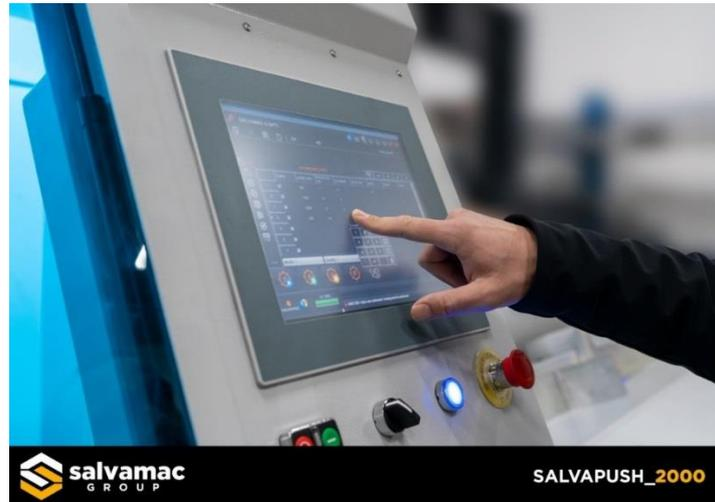
Das elektronische Betriebssystem besteht aus einer numerischen Steuerung und einem integrierten Computer der neuesten Generation, um die Kommunikationsgeschwindigkeit auf weniger als eine Millisekunde zu begünstigen. Die Benutzerfreundlichkeit und die Grafik der **Salva-OPTIM-Software** stellen die wichtigsten Systeme der smarten Elektronik dar. Programmbereiche, die der Statistik gewidmet sind, und Schnittergebnisse, mit Echtzeit-Updates, Diagnosen und Videonachrichten.
