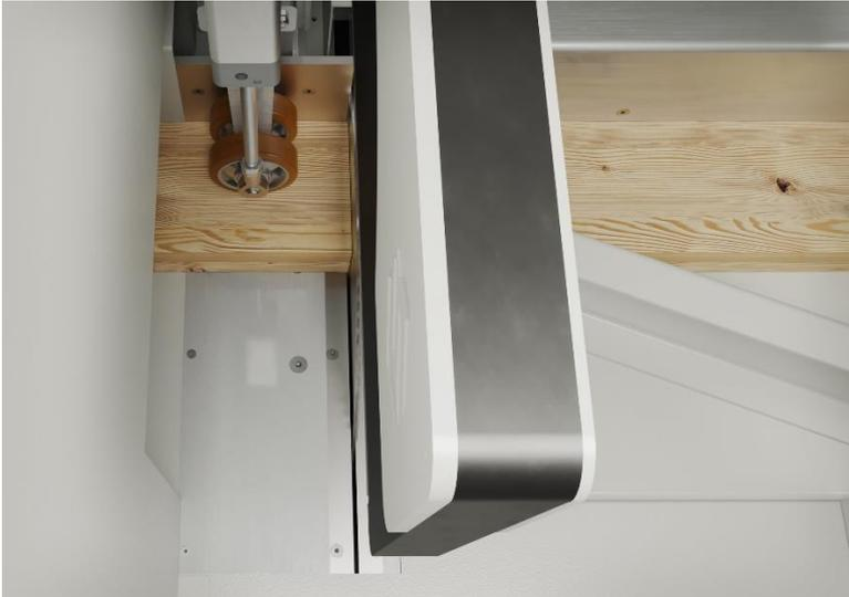
**Zwei** elektropneumatische seitliche **Ausrichtvorrichtungen** innerhalb der Maschineneinheit, vor und hinter dem Sägeblatt. **Der erste Abzieher** arbeitet **horizontal** und fungiert als Vorspanner des Werkstücks in Richtung der Führung und des Schiebers. **Der zweite** hinter dem Sägeblatt arbeitet **vertikal** und ermöglicht die Aufrechterhaltung der Präzision bei den Abmessungen, insbesondere bei den letzten auf dem Arbeitstisch geschnittenen Werkstücken. **LED-Kabineninnenbeleuchtung**
