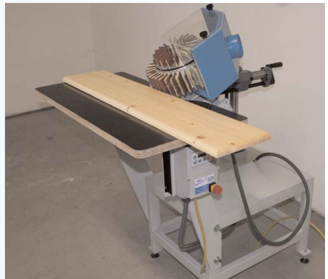
Schleifen von schräg profilierten Kanten mit der Schleiflamellenwalze in Schrägstellung nach vorne
