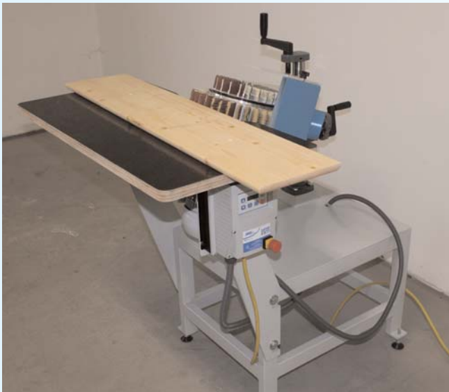
Schleifen von schräg profilierten Kanten mit der Schleiflamellenwalze in Schrägstellung nach hinten
