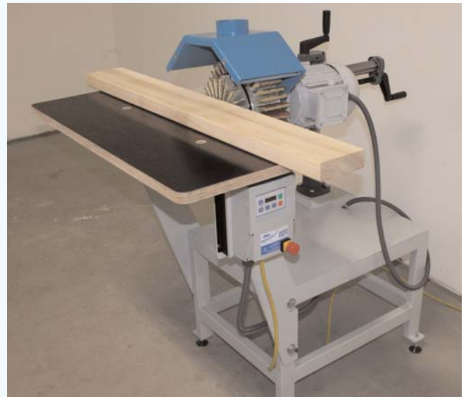
Schleifen von zwei Kantenradien in einem Durchgang mit der Schleiflamellendisc
