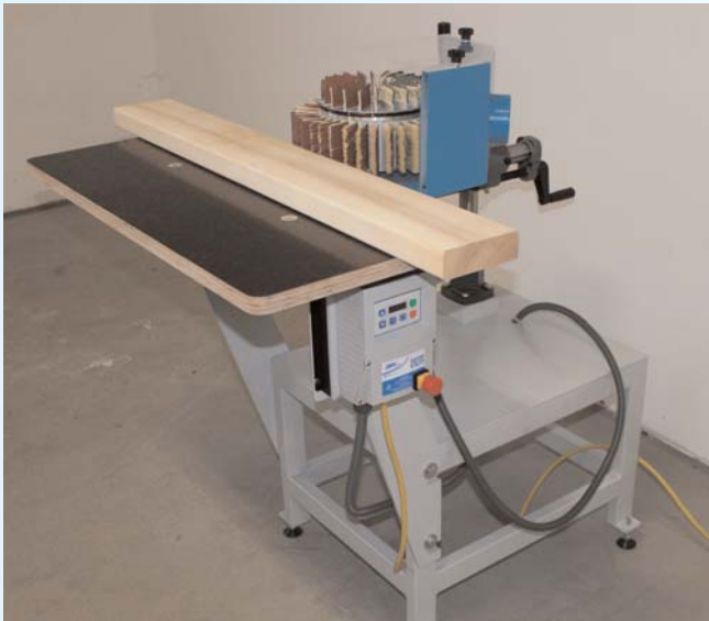
Schleifen von geraden und profilierten Kanten mit der Schleiflamellenwalze 90°
