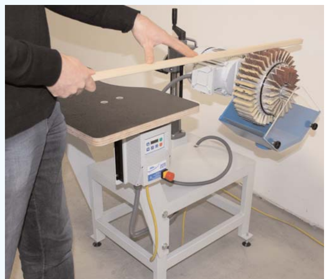
Schleifen von profilierten Leisten mit der Schleiflamellenwalze z.B. Glasleisten
