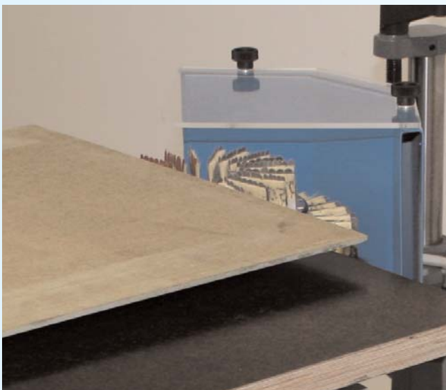
Schleifen von abgeplatteten Füllungen mit der Schleiflamellendisc
