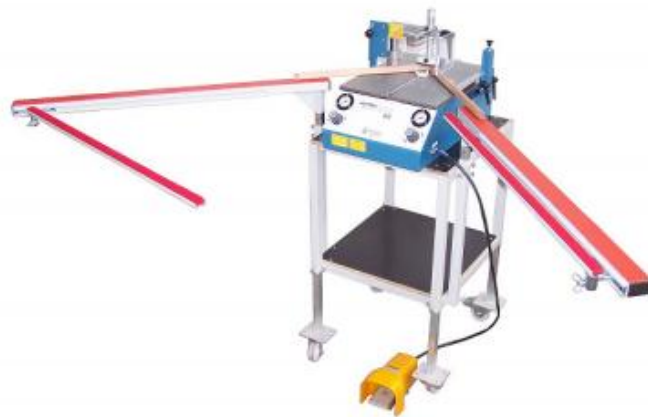
Klammer-Eckverbindungsmaschine mit Arbeitstisch und Leimangabegerät
