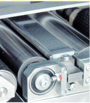
S-Oxyd-Keramik-Schleifschuh optimale Wärmeableitung, Langlebigkeit, Gleiteigenschaften lange Lebensdauer.
