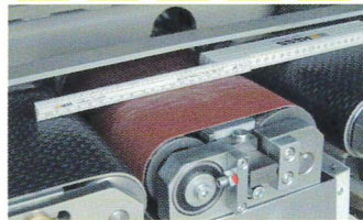
Kürzeste Werkstücklänge 280 mm.
