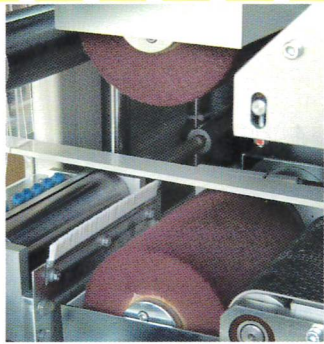
integrierte Bürst- und Finish- einrichtung (Zusatzausrüstung). Oberflächenfinish, Werkstück- /Abblase-Einrichtung mittels Flachstrahldüsen.
