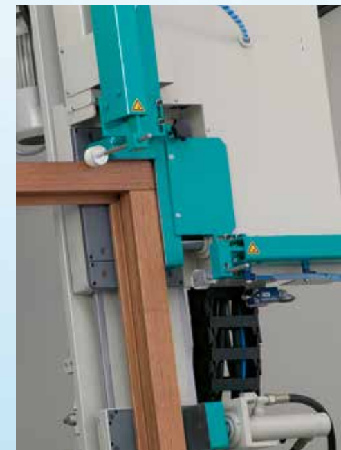
zwangsgeführte rechte obere Pressecke verhindert Zylinderkollisionen
