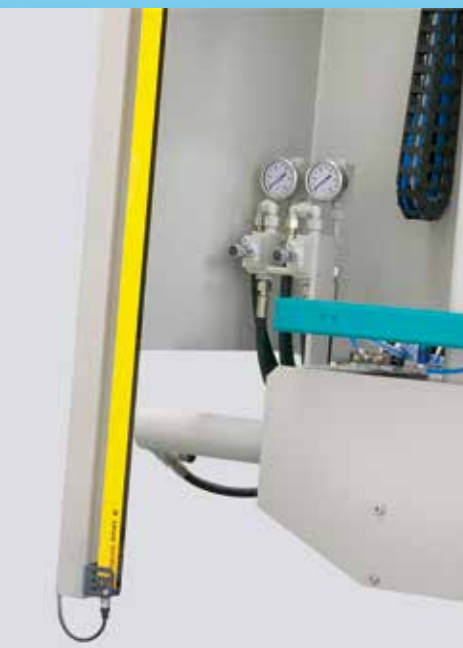
individuelle Druckregelung für vertikale und horizontale Zylinder, Sicherheitslichtschranke
