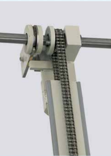
pneumatisches Auskuppeln der Druckbalken für Schräg- und Spitzfenster (Option)
