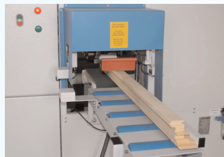
Berührungslose Werkstückbreiten- und Profilerkennung
