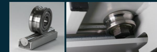
Die obere Führung besteht aus einer gehärteten Rundstange die in ein mit Epoxidharzkleber gefülltes U-Profil eingelassen und fest mit dem oberen Modul verbunden wird. So wird ein Verziehen der Führung durch thermische Belastung bei Schweißarbeiten während der Montage vollständig vermieden.
