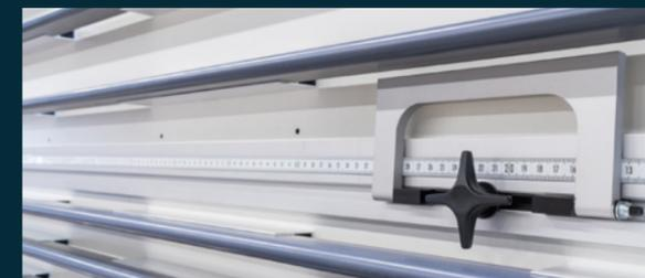
Der Anschlag lässt sich präzise einstellen, da er direkt an der Skala anliegt.
