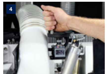
Radiale Verstellung der Druckelemente mittels elektrischer Anzeige, für automatische Anzeige und Rückkopplung des Soll-Ist-Vergleichs sowie des Korrekturfaktors
