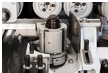
Axiale Verstellung an den vertikalen Spindeln bis zu 75 mm
