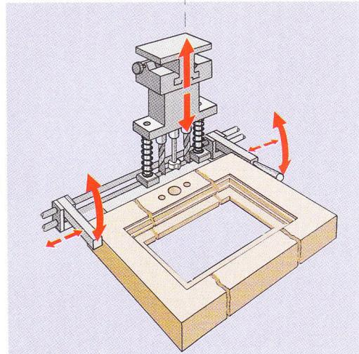
■ **Anschlagsystem** für mittiges Bohren im Fensterflügel. (Sonderzubehör)
