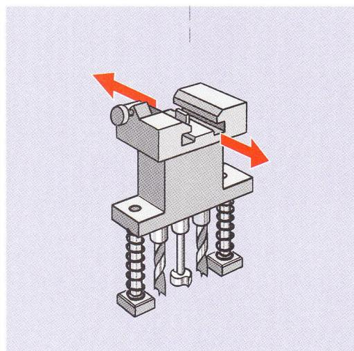
■ Bohrkopf BKF 3 – schnellwechselbar; 21,5 mm Teilung für Griffoliven.
