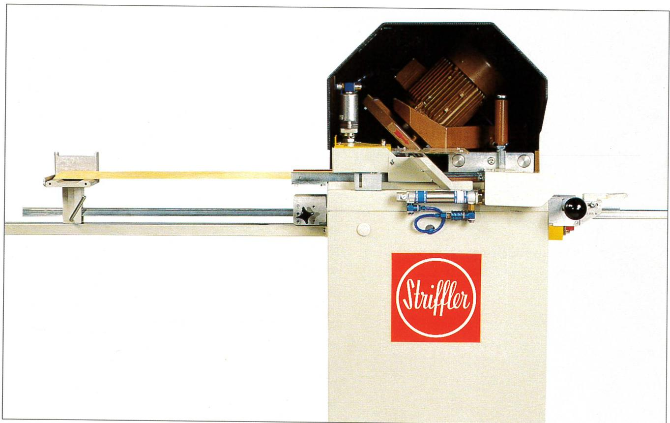
Die Gehrungssäge (Glasleistensäge) 2733 ist die ideale Maschine zum Sägen von Leisten (Glasleisten) auf 45°, insbesondere bei Holz.
