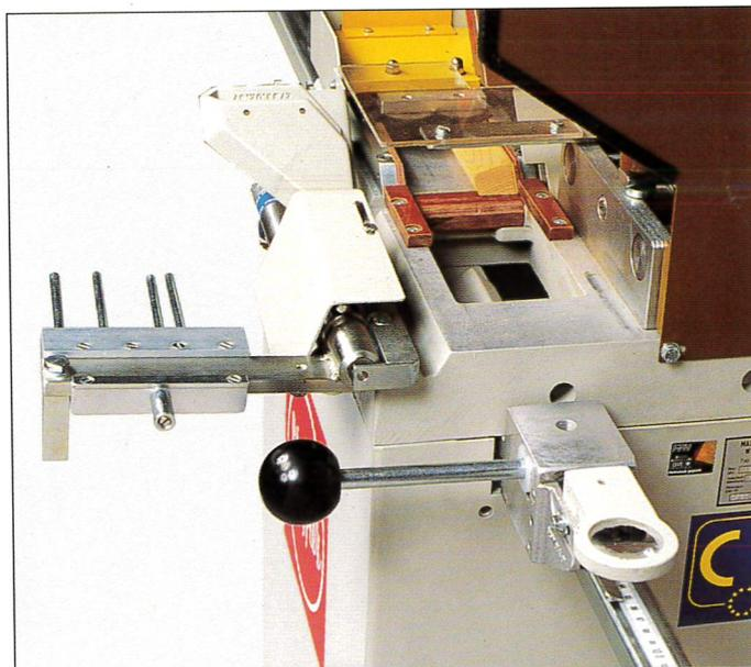
Beim Profilieren ausgetrennte Glasleisten mit Schlitz und Zapfen werden mit Hilfe eines pneumatisch-automatischen Spezialanschlags exakt auf ihre Endlänge gesägt.
